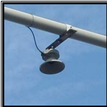
超音波式車両感知器
