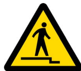
下り段差注意 Caution, uneven access / down
