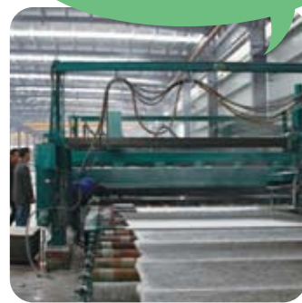
ウォータージェットによる仕上げ
