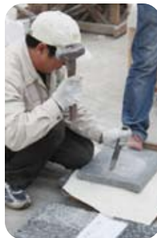
手作業での荒ノミ仕上げの様子
