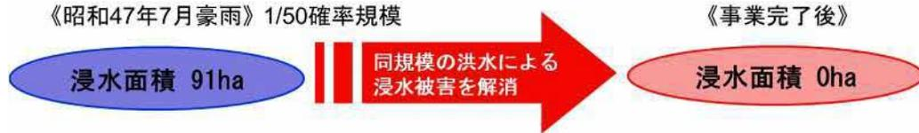
○波積ダムの完成により、河道改修（改修済）とダムによる洪水調節効果により、ダム下流の都治橋基準点の水位を2.3m低減することができます。
