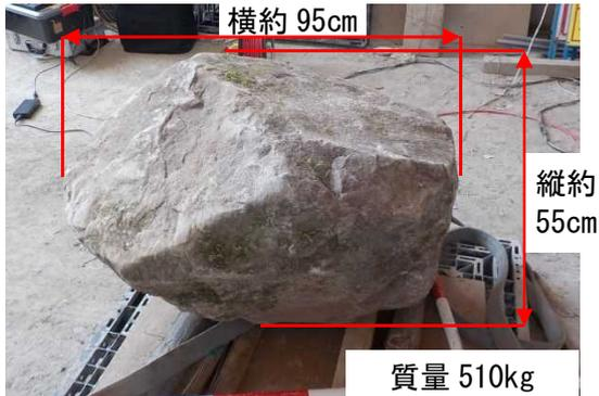
図-3 落下岩塊の 3D 模型
