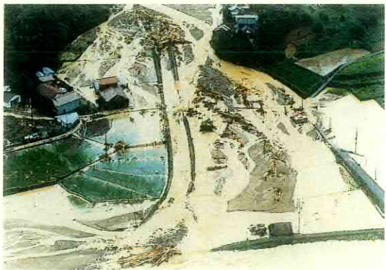
堤防決壊に加えて土石流が発生（浜田市）
