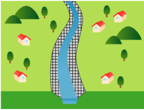
被災箇所のみの原形復旧
