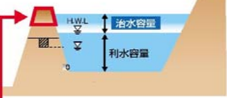
堤体に盛土をし、余水吐を高上げし、治水容量を確保
