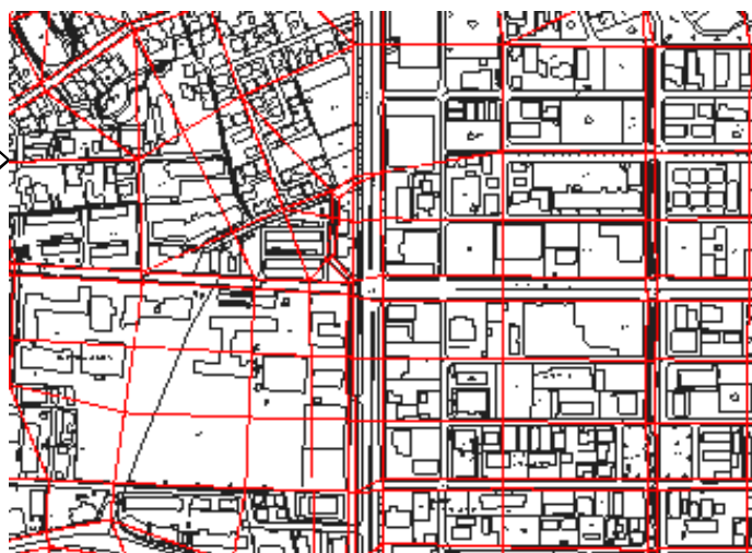
氾濫解析(平面2次元解析)モデルのメッシュ分割方式
