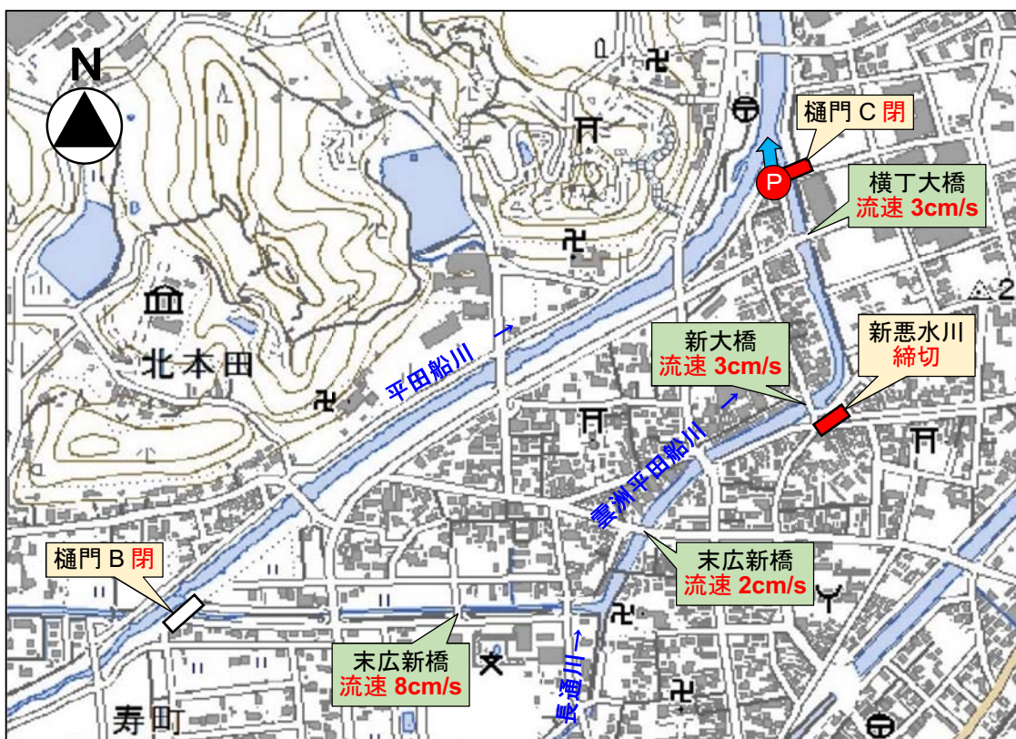
図-3.3.12 ポンプ稼働試験概要（第2段階）
