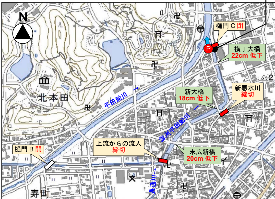
図-3.3.11 ポンプ稼働試験概要（第1段階）
