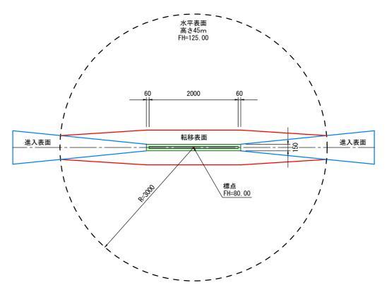
進入表面、転移表面および水平表面の平面図
