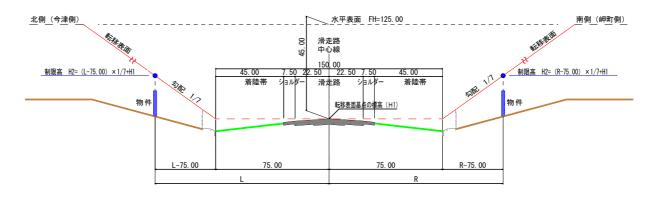
転移表面および水平表面の側面図
