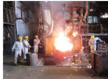
特許第 3707675 号 実用化試験の様子 (渡部製鋼所：溶解工程)
