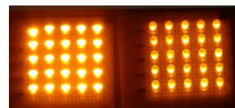
反射型 LED 試作品 斜め下から見た点灯状態 左:試作品、右:通常品
