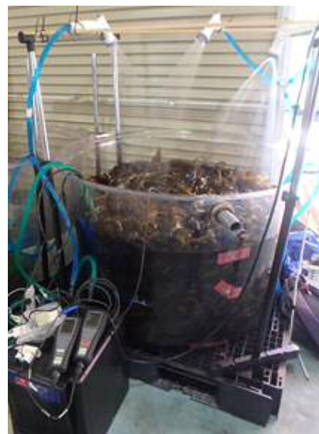
写真 2. ワカメの高密度ストック試験
