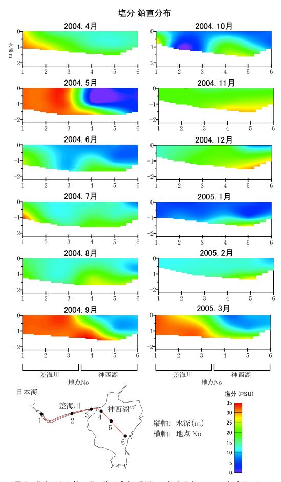
図3 差海川から神西湖の塩分濃度 (PSU) の鉛直分布 (ライン鉛直断面)
