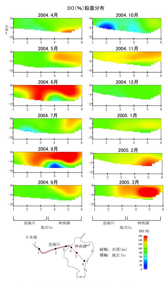
図4 差海川から神西湖の溶存酸素濃度(%)の鉛直分布(ライン鉛直断面)
