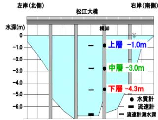
※上層の水質データおよび流速データは全て欠測となっています。(機器故障のため)
