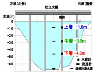
上層の水質データおよび流速データは全て欠測となっています。また、中層の塩分も欠測となっています。(いずれも機器故障のため)
