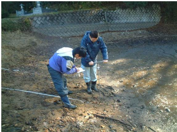
コーンペネトロメータによる地耐力及びヘドロ厚測定
