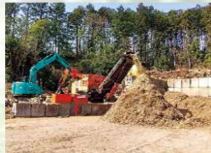
木材を破碎することにより、木質チップを生産(チップ生産業)
