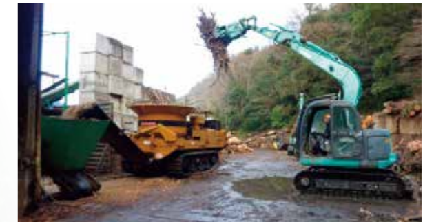
移動式チップパーによるバイオマス発電用チップの生産作業
