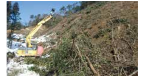
スイングヤードによる集材作業
