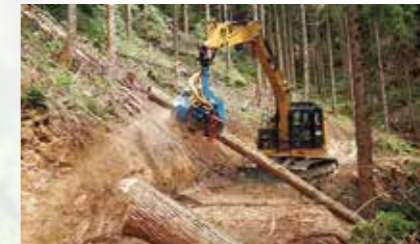
ハーベスタによる伐木造材作業
