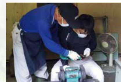
刈払機刃の研磨作業
