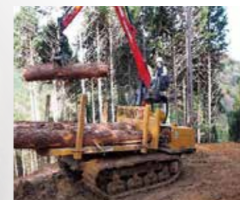
フォワーダ運材作業
