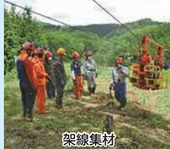
スウィングヤードを使った 簡易架線集材
