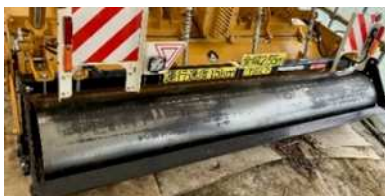
整地部分を改造した鉄ローラー
