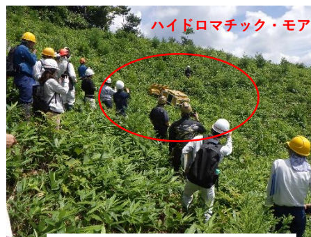
林地での実演状況 →35度程度の傾斜の刈払可能
