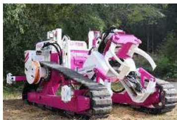
〈遠隔操作式伐倒機〉
