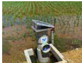
【スマートフォンで遠隔で操作・管理できる多機能型自動給水栓】
