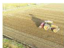
【自動操舵トラクタによる播種作業】 【自動操舵技術を搭載したトラクタ】
