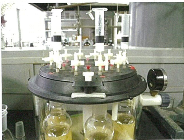
写真1 色素等を除去する操作 （分析精度を高めるための事前処理）
