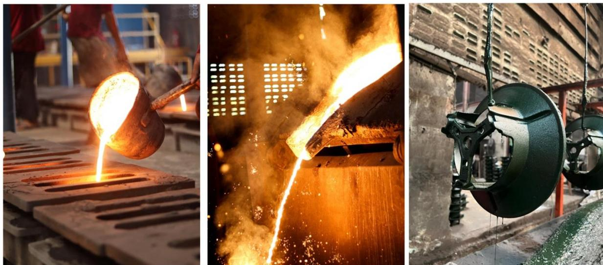
電気炉による金属溶解、金型製作、そして塗装工程を含む社内製造プロセス。
