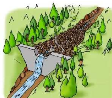
大雨等の出水等で砂防堰堤の堆砂敷が満砂
