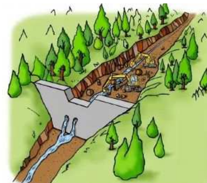
次の出水による土石流に備えて土砂を撤去
