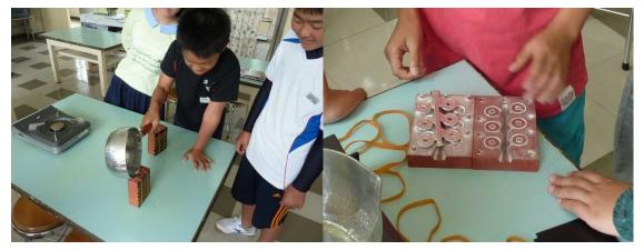
▲ 溶けて液体状になった合金の流し込み。 ▲ 鋳型を開けたら和同開珎の出来上がり!
