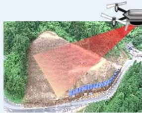
ドローンによる3D測量
