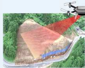
ドローンによる3D測量
