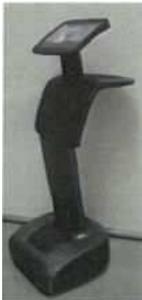
temi (テミ) : 児童のタブレットからの指示で遠隔操作や自律移動可能なロボット
