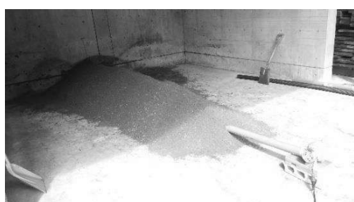
写真1 廃菌床の送風乾燥
