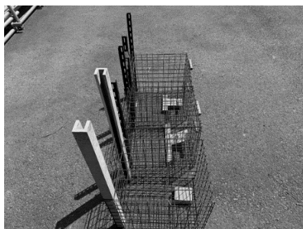
写真5 ワイヤーメッシュで試作したノウサギ捕獲わな
