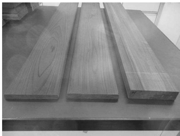
写真1 左：50％圧密材、中：44％圧密材、右：窒素加圧加熱処理ヒノキ原板
