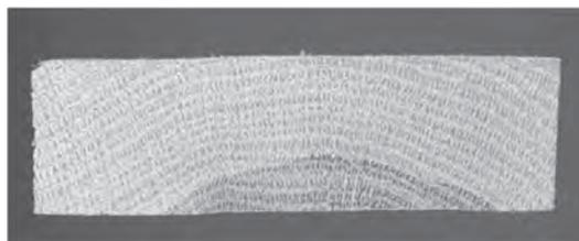
写真-1 乾燥後の試験体中央から採取した試験片の木口面
