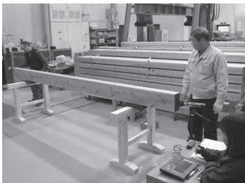
写真-1 打撃音法によるスギ心去り平角の動的ヤング係数（ $E_{fr}$ ）の測定
