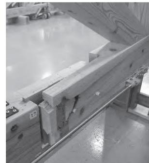
写真-3 下弦材継手での破壊 (梁せい 240mm)
