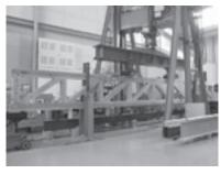
写真-1 平行弦トラスの 曲げ試験
