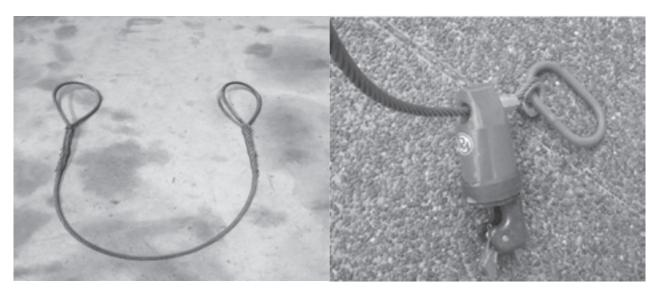
写真-1 従来のワイヤー(左)と自動荷外しフック(右)
