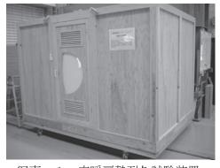
写真-1 床暖房熱耐久試験装置
