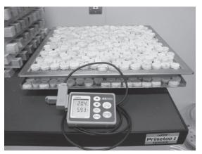
写真-2 養生中の試作埋木コマ
