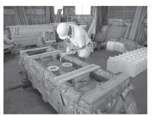
写真-4 注入槽への薬液の入れ込み
