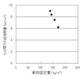
図-1 塗装したスギ小試験体での薬剤固定量と総発熱量との関係
