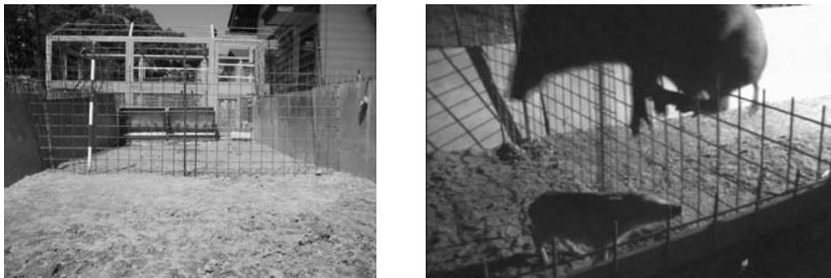
写真-1 試験の様子 (左：ワイヤーメッシュ柵の試験状況，右：ワイヤーメッシュ柵を跳び越えるイノシシ)
