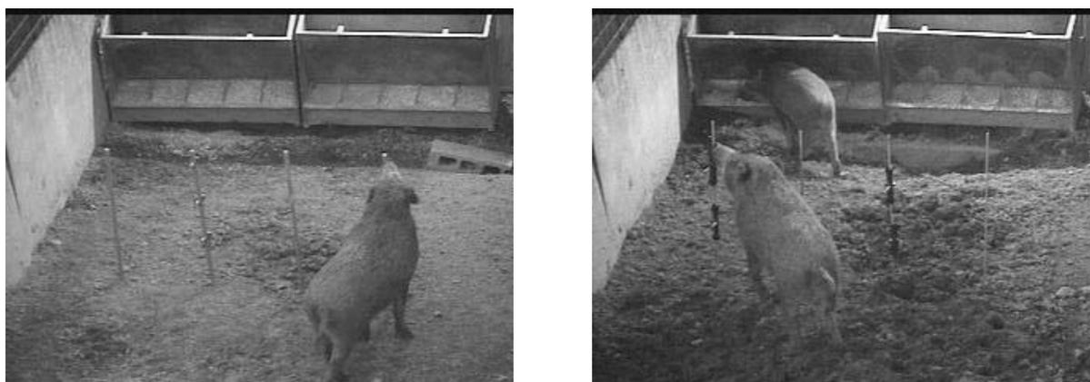
写真-2 碍子に鼻先を接触させるイノシシ (左：碍子タイプA, 右：碍子タイプB)
