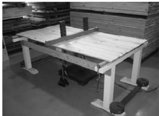
写真－1 幅はぎ板のMOE測定
