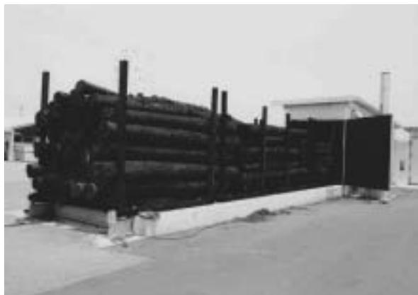
写真-1 煙熱処理後のスギ丸太
