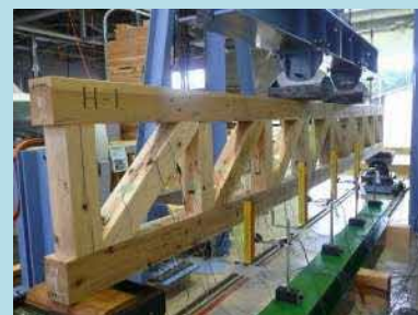
実大曲げ試験（ハウトラス）
