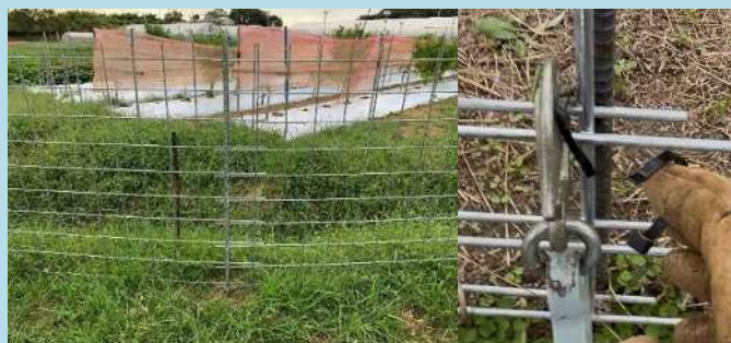
図2 設置したワイヤーメッシュ柵と破損した結束バンド
