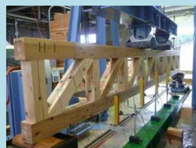
実大曲げ試験（ハウトラス）
